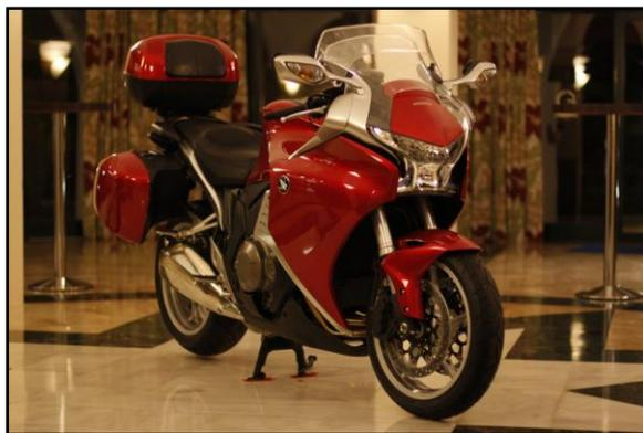
So wurde in ihr die auf der Intermot 2008 vorgestellte Studie des X-Face Scheinwerfers perfekt umgesetzt, der sich nahtlos in die zweilagige Verkleidung einfügt, welche durch ruhige Linien und absolut cleane Flächen aufwartet. Diese doppelte Bauweise dient aber nicht nur der Optik. Sie soll vielmehr den ankommenden Luftstrom ohne jegliche Verwirbelung ins und ums Motorrad leiten, es somit auch bei hohen Geschwindigkeiten durch
