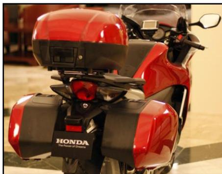
Apropos hinten. Hier hat sich Honda auch wirklich mal was einfallen lassen, wie man ein Kofferträgersystem platzsparend und vor allem absolut unauffällig integrieren kann. So kann man einfach und schnell das Original Honda Kofferset und Topcase anbringen, ohne Schraubarbeiten verrichten zu müssen. Kleines Manko ist aus meiner Sicht, dass in das Topcase nur ein Helm passt – dafür schaut's aber auch super und absolut passend zum Bike aus.
